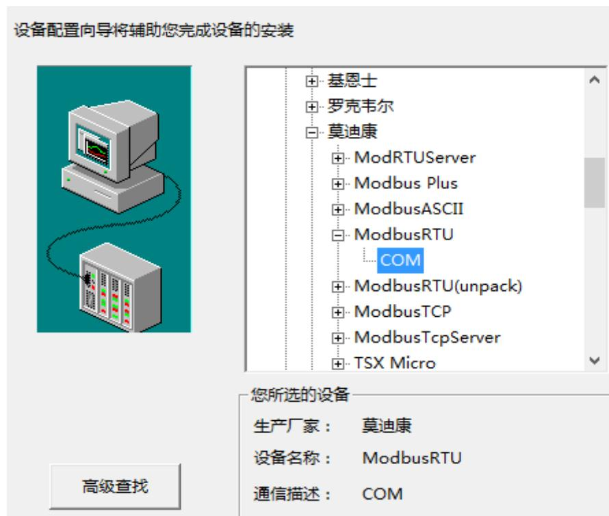
通信端口选择与 PLC 连接的计算机串口，如下图示例中为 com2。
