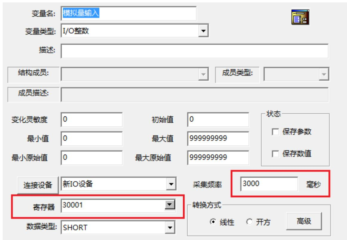
然后在组态王的画面中新建图形控件连接 I/o 变量，即可运行画面开始采集 PLC 的相关寄存器的数据，如数据显示正确，即完成组态软件和 PLC 通过本地串口以 Modbus RTU 方式数据通信过程。
