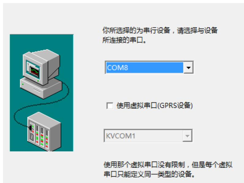
comway 无线串口软件在每个计算机上最多可以添加 128 个虚拟串口，而多个 DTU 可以映射到同一个虚拟串口（只要连接的设备的 modbus 地址不同），则组态软件可以同时与 500-1000 个 modbus 设备通过 DTU 建立 gprs 数据通信。
