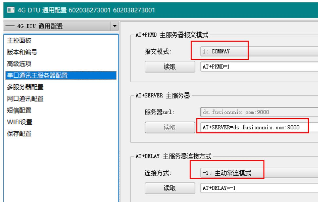
在计算机端安装 Comway 无线串口软件，DTU 插入 sim 卡上线后，将会在如下界面中显示 ONLINE，再映射 DTU ID 到添加的虚拟串口 **COM8**，如下图所示：
